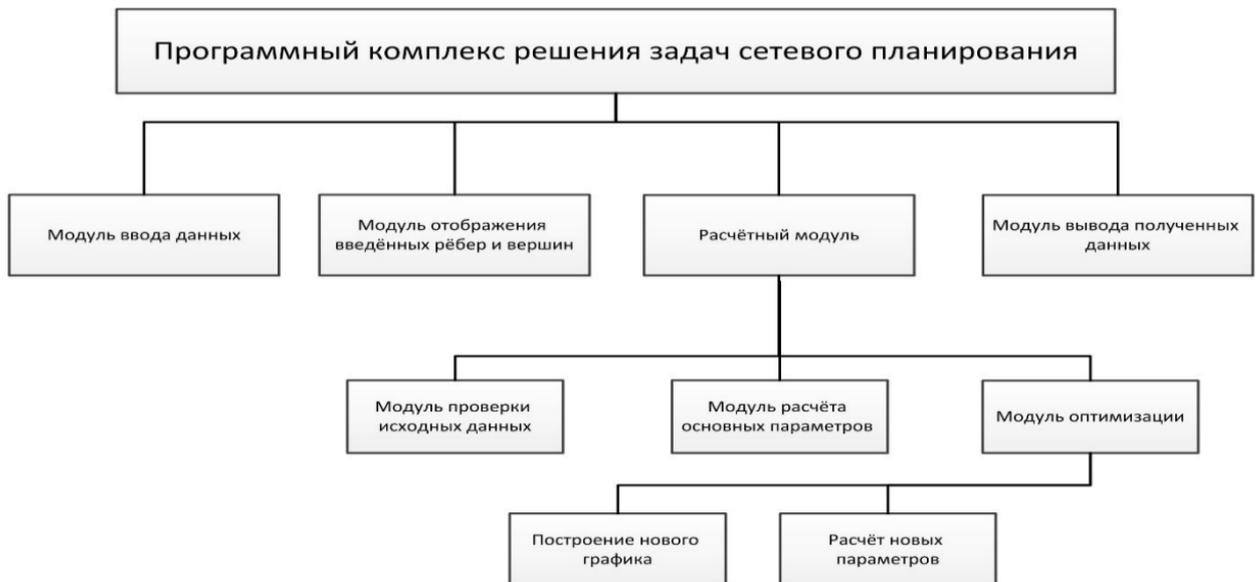
Рис.2.12 Структурная схема программного комплекса решения задач сетевого планирования
